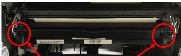
1. 転写ローラー両脇のレバーを押し下げる
