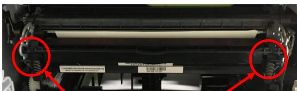
両側のレバーを押し下げると、ローラーとベルトの間に隙間が出来ます。
